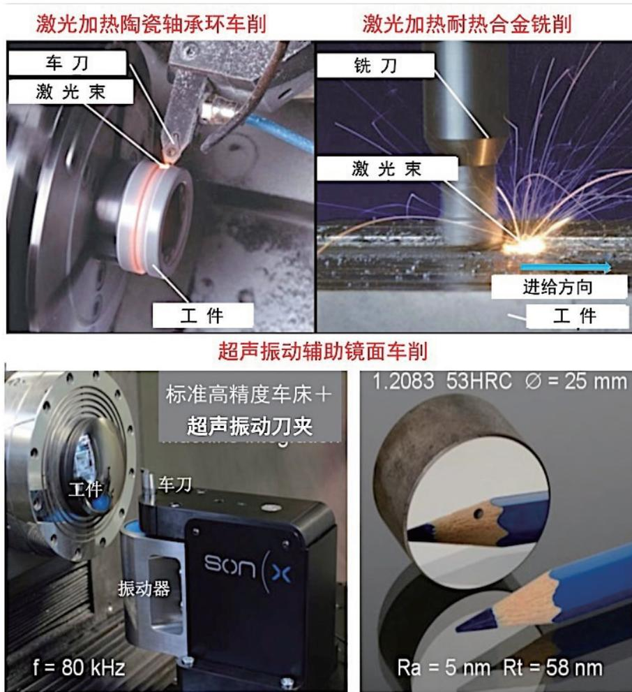
图 1 激光加热和超声振动辅助加工
