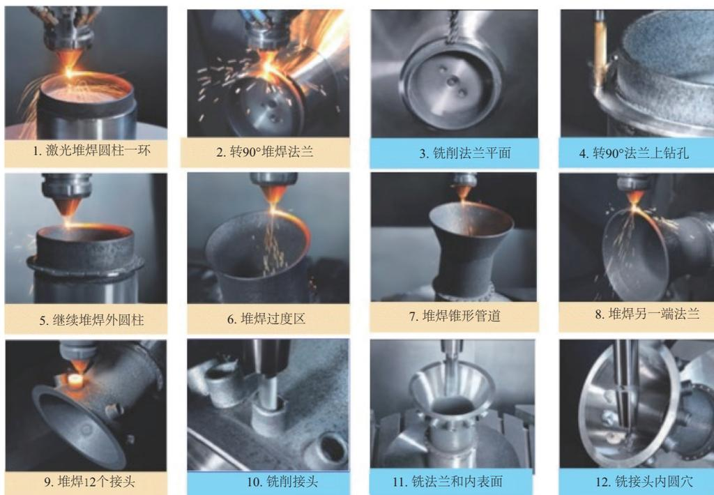
图7 涡轮增压壳体的 12 道混合加工工序
