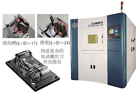
图 3 Lumex Avance-25 混合加工机床及其加工案例
