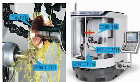
图 2 电加工和磨削混合加工的刀具机床
