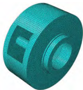
图 2 行星架有限元网格模型
